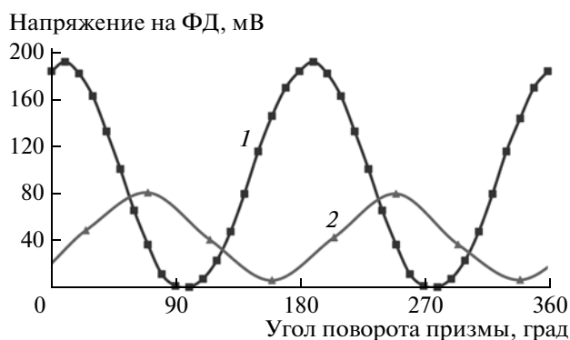
Рис. 2. Зависимость напряжения на ФД от угла поворота поляризатора для горизонтальной поляризации излучения лазера при неподвижном ОД (1) и при частоте вращения ОД 80 Гц (2).
